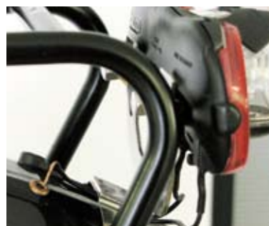
Kwetsbare draadverbinding achterlicht
