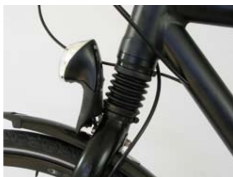
Voorvering fraai weggewerkt in de balhoofdbuis
